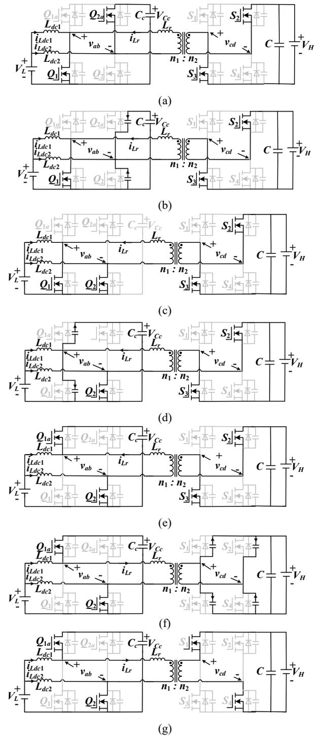
Fig.3. Operation modes of the boost mode. (a) Before  $t_0$ . (b)  $t_0$ - $t_1$ . (c)  $t_1$ - $t_2$ . (d)  $t_2$ - $t_3$ . (e)  $t_3$ - $t_4$ . (f)  $t_4$ - $t_5$ . (g)  $t_5$ - $t_6$ .
