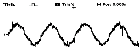
(b) 输出线电压(100 V/div), 时间(10 ms/div)
